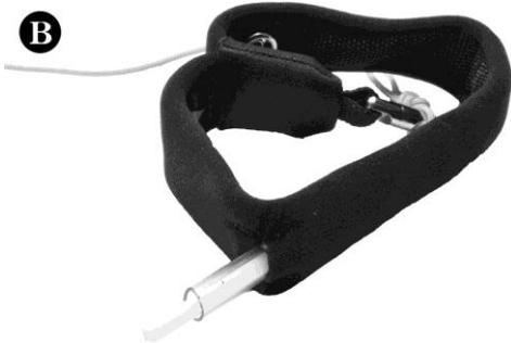
Per rimuovere la parte rigida delle maniglie dei freni girate le stesse al contrario e sfilate le due plastiche cilindriche lunghe circa 10 cm.
