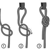
Fig. 4. Overhand- knot
