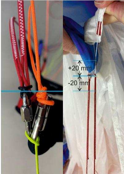
Fig. 9 punto di misurazione veloce per i freni
