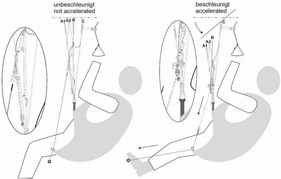
Fig. 6 Come lavora il sistema di velocità VERSORS
