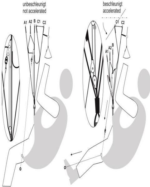
**Fig. 12** Come lavora il sistema di velocità del NYOS RS
