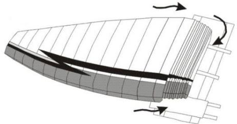
**Fig. 12:** Ora ponete la sacca di protezione sotto la parte piegata con la sezione di vela piegata insieme e giratela di 90 ° in modo da porre tutta la vela sopra la sacca stessa.
