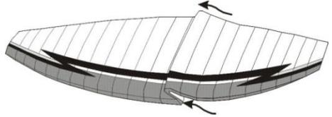
**Fig. 11:** Tutte le centine vanno avvicinate una all'altra curando che le bocche stiano simmetriche e i rinforzi in plastica non vengano piegati.
