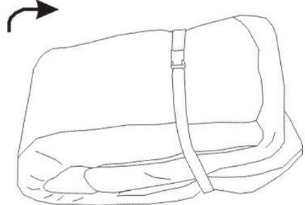
**Fig. 15:** Piegare ancora una volta il parapendio. Quando mette la cinghia di compressione fate uscire l'aria in modo gentile. Controllate che il parapendio sia piegato in modo leggero e che non sia compresso o piegato eccessivamente.
