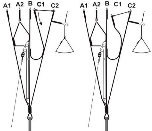
**Fig. 7:** Aggiustamento della direzione di volo tramite il ponte sulle C.
